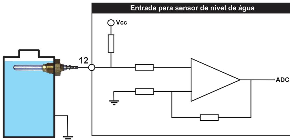
O sensor deverá ser rosqueado na carcaça metálica do radiador de forma que a ponta fique em contato com a água. A própria resistência da água servirá como condutor, indicando a presença do líquido.
