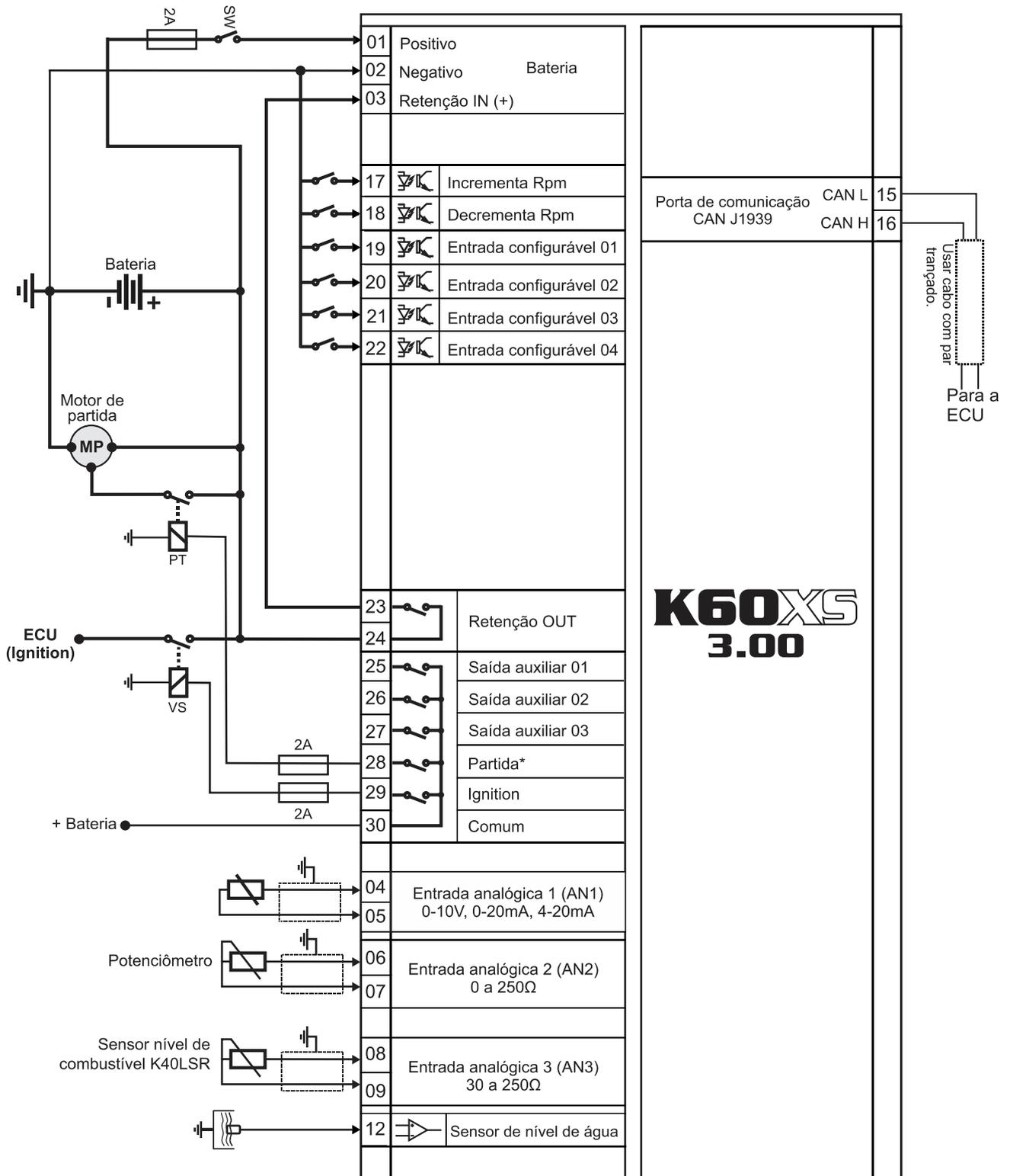
\*Nos motores Scania e Volvo não há necessidade de instalar o relé de partida, pois isto é feito através de comando J1939.
