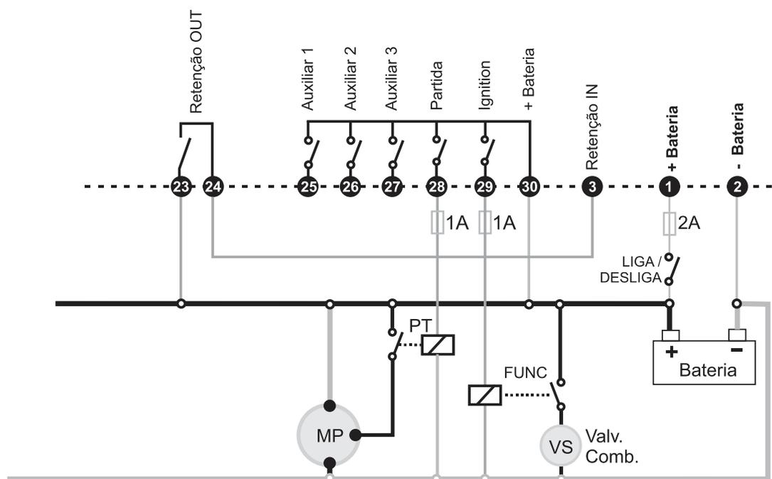
Ligação de relés externos evita que corrente da carga circule pelos contatos dos relés internos do controlador.
